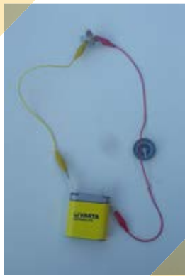
Bild 6a: Stromkreis nicht geschlossen – Kompassnadel zeigt nach Norden
