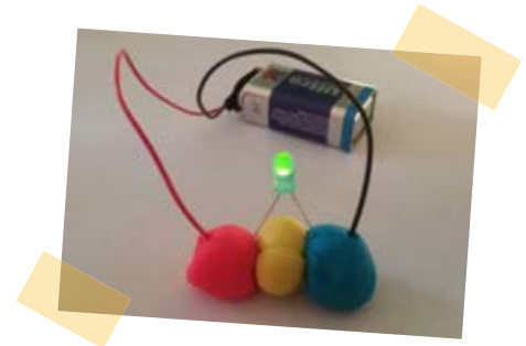
Bild 19a: Einfacher Stromkreis mit Knete
