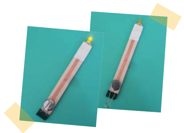
Bild 20: Selbstgebastelte Taschenlampe - Licht an! Licht aus!
