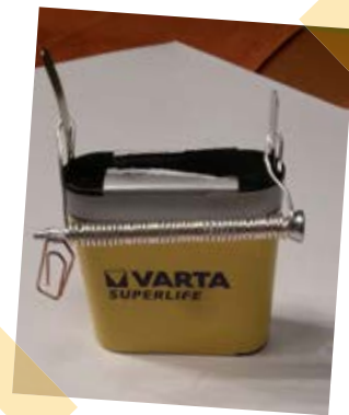
Bild 5: Aufbau zum Testen der Leitfähigkeit verschiedener Materialien. Hier: Büroklammer
