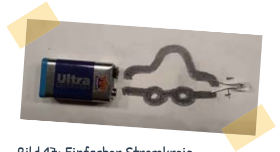
Bild 17: Einfacher Stromkreis mit Graphit
