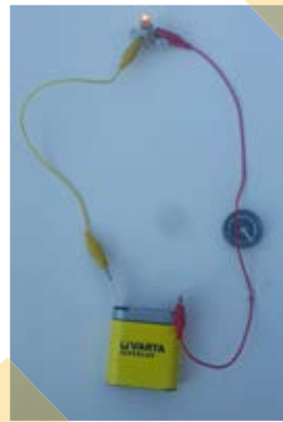
Bild 6b: Stromkreis geschlossen – Kompassnadel wird abgelenkt
